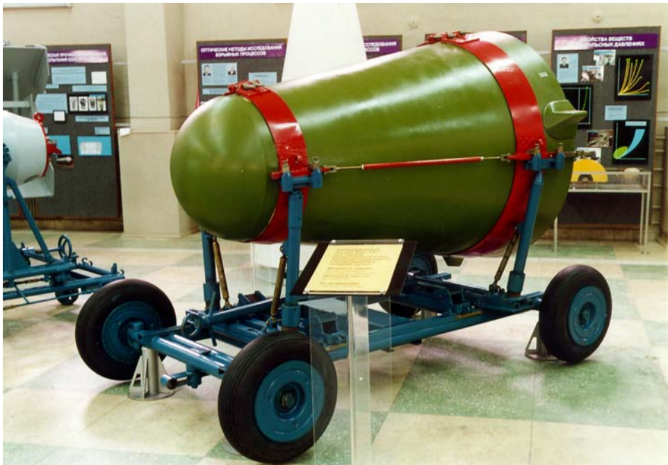
Боевой блок для РГЧ стратегической ракеты с термоядерным зарядом. На вооружении с 1970 года. Энерговыведение более 2 Мт ТЭ. Музей ядерного оружия РФЯЦ-ВНИИЭФ. (Архив Минатома)
